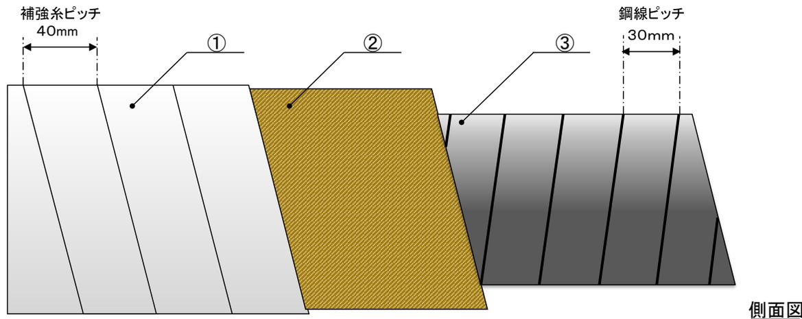
①表面材 ポリエステル補強糸入りアルミニウム蒸着
