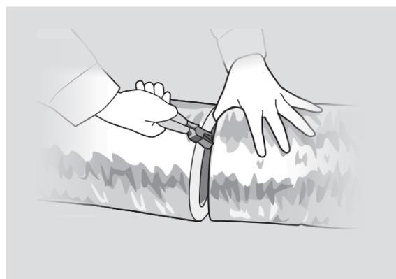
**4** インナーコアの鋼線はニッパーやワイヤーカッターで切断します。
