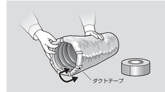
**5** ダクトテープでインナーコアとグラスウール、アウタージャケットがずれないように固定します。この時(4)で切断した鋼線小口もダクトテープで覆います。
