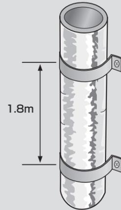
吊り間隔は1.5m以内にして、吊りバンドは幅3.8cm以上の物を使用して下さい。
