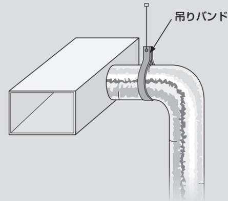
高温を発生するファーンレス、ボイラー、蒸気配管等の近くへの設置は避けて下さい。
