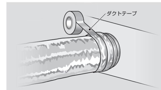
**8** 固定バンドの上から接続先にかけてしっかりとダクトテープを巻いていきます。この時ずれないように、できるだけ強めに巻いてください。
