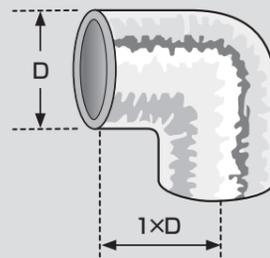
下方向へ配管する際は、カラーのエッジでダクト内側を傷付けてしまう恐れがあるので図の様に支持を取って下さい。
