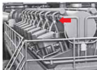
エンジンコンプレッサーに 取り付けられた 〈フレックスカップリング〉
